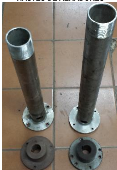
HASTES DE AERADORES
