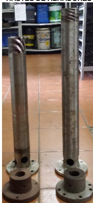
HASTES DE AERADORES
