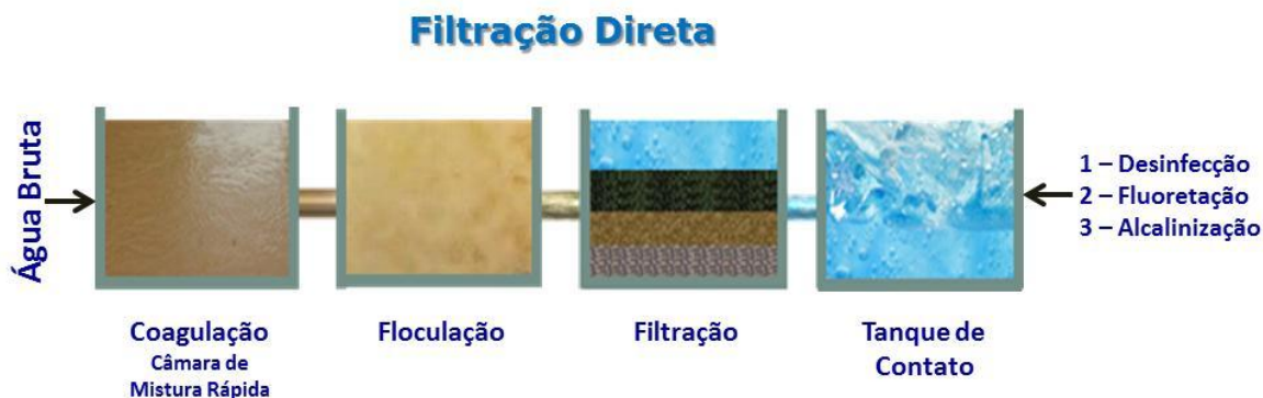
Figura 18 – Fases do tratamento de água no sistema filtração direta.
