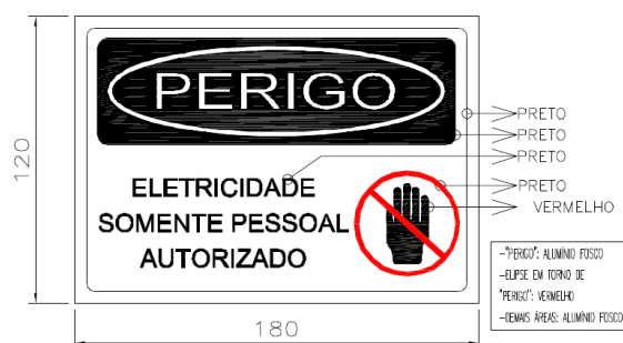
Figura 1 – Placa de Advertência de Risco Elétrico.
