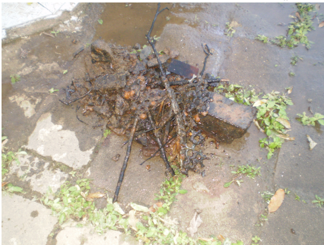
Fig. 4 Alguns detritos encontrados poços de sucção.
