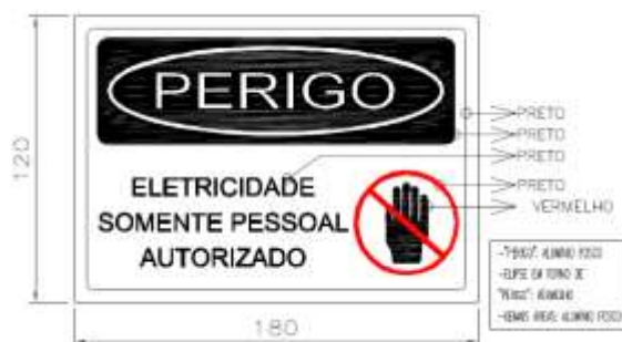
Figura 1 – Placa de Advertência de Risco Elétrico.
