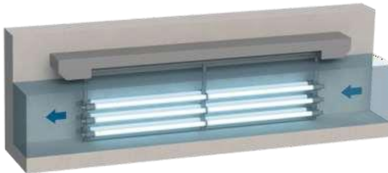
Figura 3: Sistema de desinfecção por UV em canal aberto – lâmpada horizontal de baixa intensidade.
