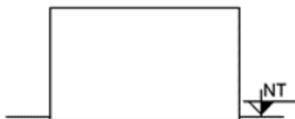
Figura 10 – Posicionamento do reservatório em relação ao solo.
