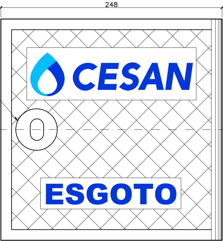
TAMPA CAIXA DE LIGAÇÃO ESC.:1/25
